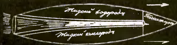
Схема межпланетного корабля из труда К. Э. Циолковского «Исследование мировых пространств реактивными приборами» (1903—1926 гг.).
